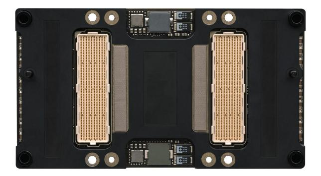
Figure 12. Tesla P100 Accelerator (Back)
